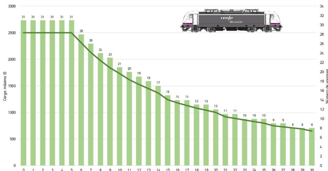
Figura 11. Carga máxima y número de plataformas MMC cargadas remolcables por una locomotora de la serie 253, en función de la rampa característica.
